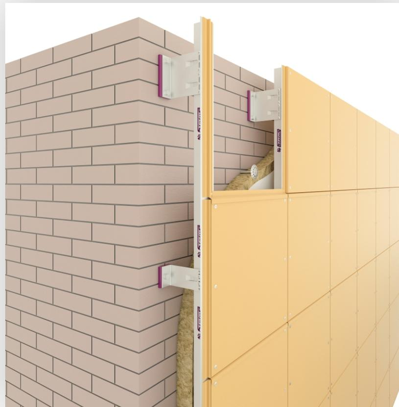
Технологически предусмотрена возможность крепления несущих кронштейнов только на 2 анкера, что, по мнению экспертов, обеспечивает максимально надежное крепление кронштейна к стене. Используются специальные терморазрывы толщиной 10 мм, которые исключают взаимодействие системы с основанием стены и служат надежной термоизоляцией.
